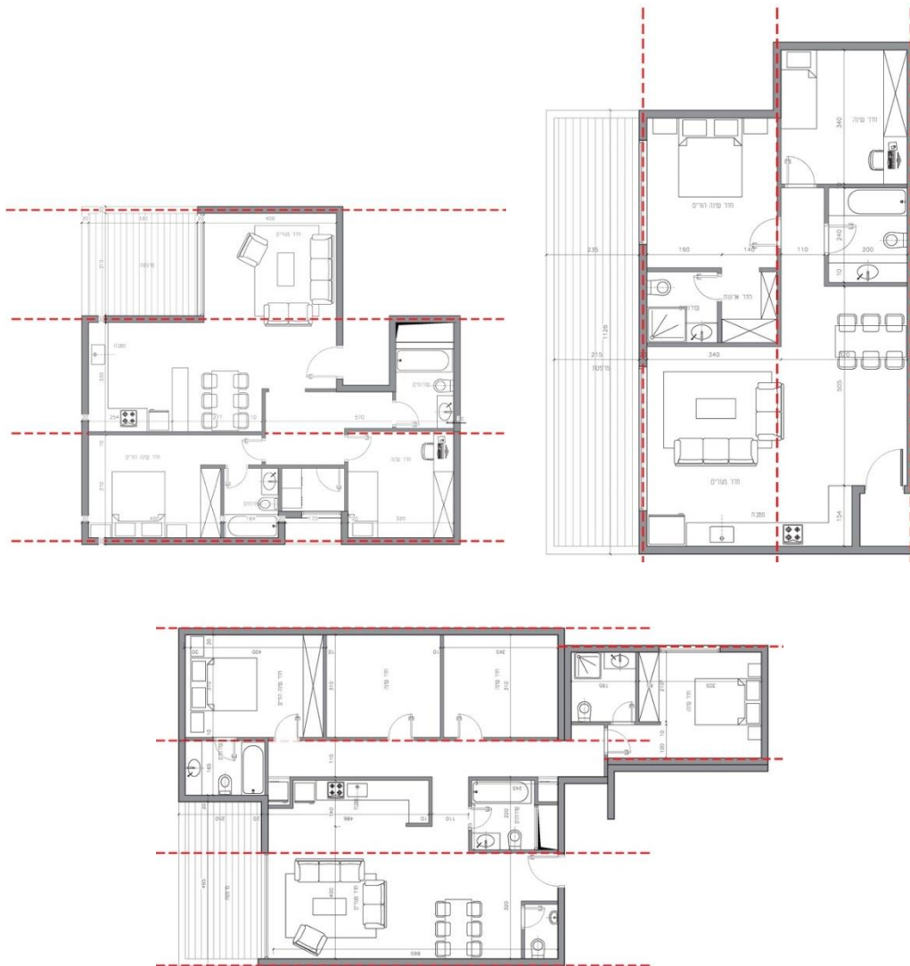
ציור 8.1.4: אפשרויות פתרון למרפסות (למעלה שמאל: מרפסת סלון כחלק מיחידה מודולרית, למעלה ימין – מרפסת כיחידת נפרדת. למטה – מרפסת גדולה המבוססת על חלקים משתי יחידות מודולריות)
