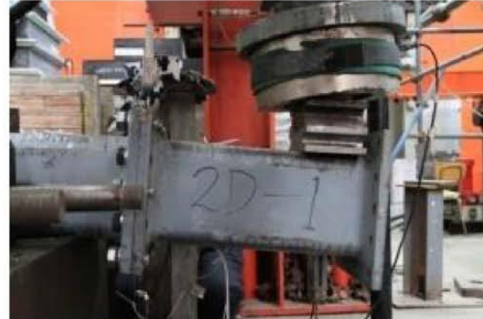
(d) Segment 1 connection failure mode
